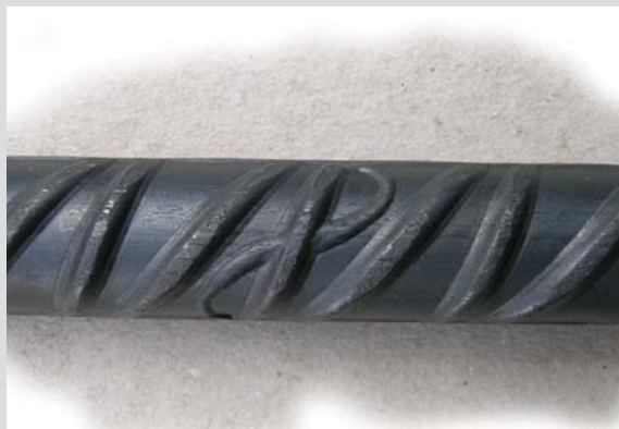
Esempio di marchiatura delle barre SISMIC
