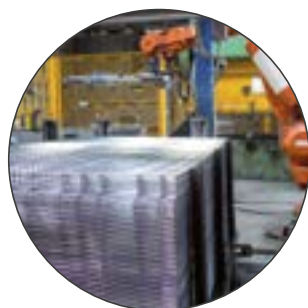
Automazione piegatura rete
